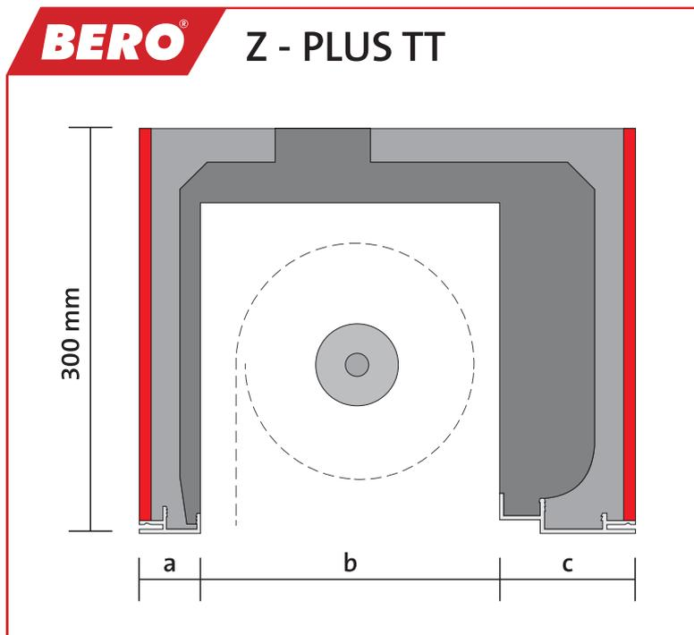
Selbsttragender Rollladenkasten aus bewehrtem BEROpor-Leichtbeton mit fest einbetonierten Ziegelblenden und einer **inneren Montageöffnung**.
